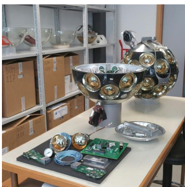
Algunos de los elementos del interior de uno de los módulos ópticos
